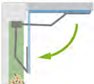
Ecoinçon réduit Encombrement minimum du bras articulé
