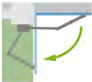
Ecoinçon réduit Encombrement minimum du bras articulé
